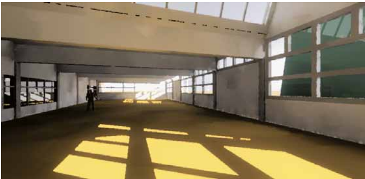
Abb.: Besonnung der Halle am 21.03. um 9:00 Uhr (Simulation)
